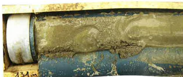
Abb. 9 – R8: Kernprobe 102 mm, im Liner, gebohrt mit Seilkernrohr CSK 146 Meth. IV. 131 m Tiefe
