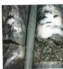
Abb. 6 – Phyllitische Schiefer mit Quarzgängen und Störungszonen. Ein Doppelkernrohr hält Rotation und Spülung vom zu erbohrenden Kern ab. Ohne Bergung dieser weichen Formation würde eine freie Kluft vorgetauscht. Folge wäre eine Fehleinschätzung für eine Injektionsmaßnahme mit Zementsuspension.
