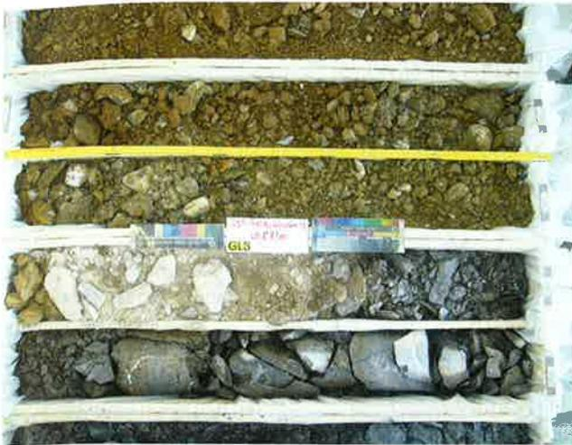
**Abb. 2** – Im Übergang von Auflockerung zu kompakten Fels. Das Bohrvfahren wurde bei den hellen Proben von „Trocken“ auf „Nass“ umgestellt. Die Drehschlagenergie führt zur Gesteinsmehlbildung und zur Erhitzung.
