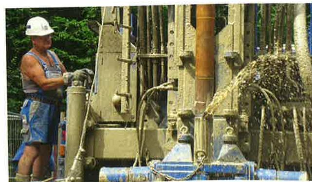
Abb. 7 – Spülbohrung CSK 146, Kern 102 mm
